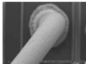
1st側：Cuワイヤ腐食なし
