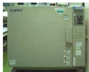
蒸気加圧試験槽 ( +105^{\circ}\text{C} ～ +140^{\circ}\text{C} 、75～100%)
