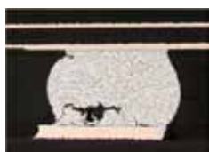
BGAクラックによる不良発生 例
