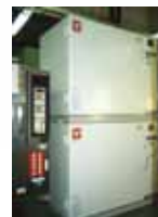
恒温槽 ( 260^{\circ}\text{C} MAX)
